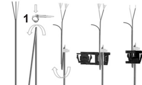
Vorgehensweise bei dünnem Pulsgeberkabel (1) Kabelbinder
